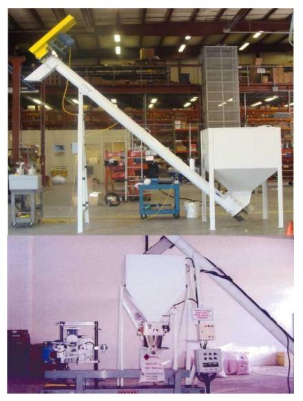
Модульная линия по производству Смесевых взрывчатых веществ из невзывчатых компонентов. Произведена по технологии ООО «Нитро-Технологии Саяны»
