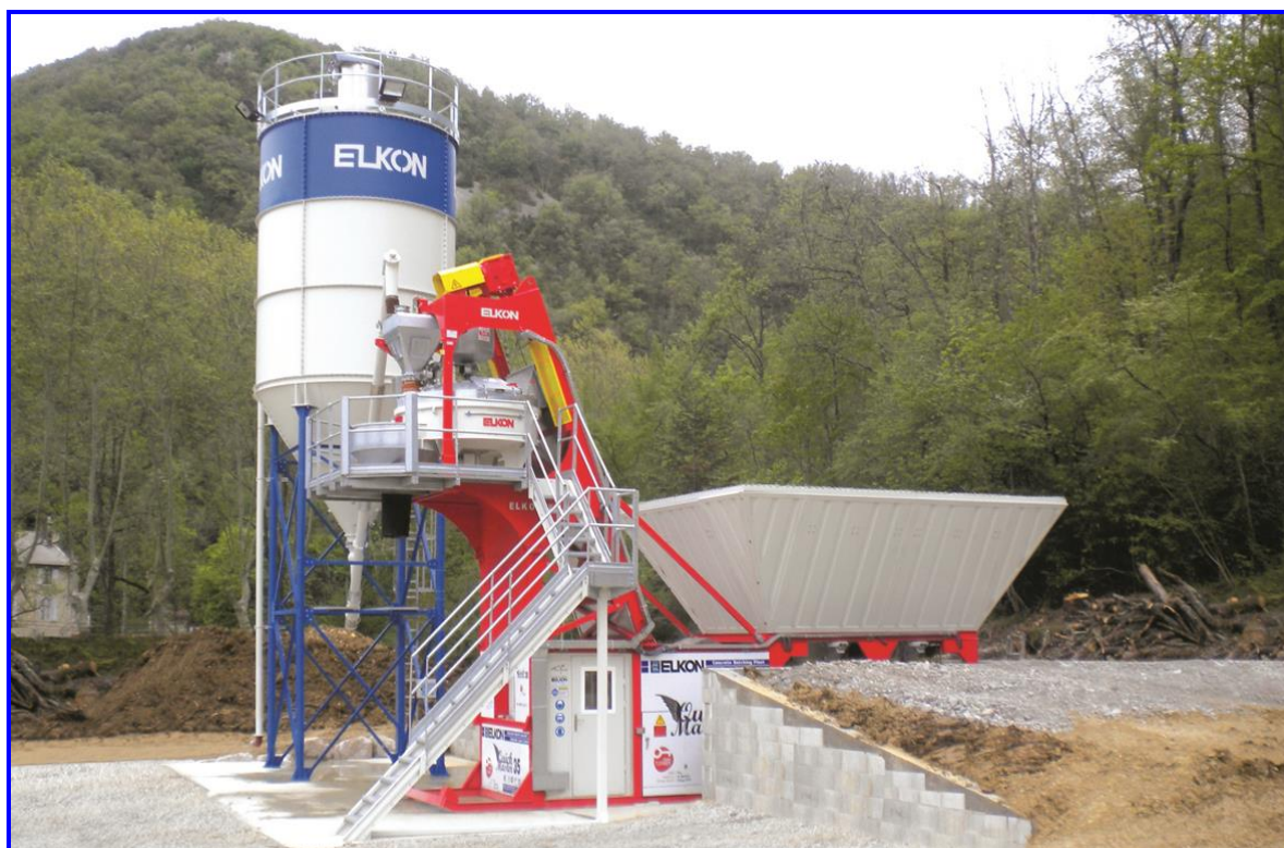
Фото-1. Общий вид установки по производству бетона
